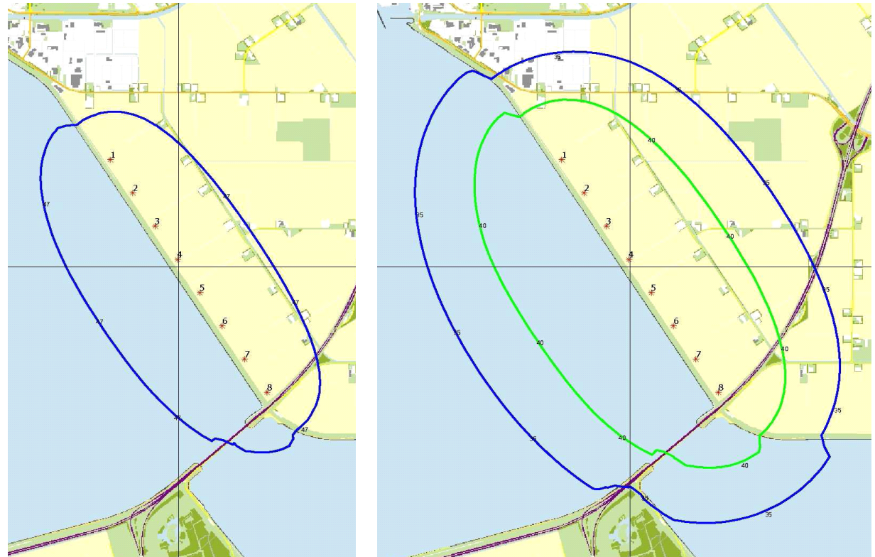
Figuur 2. Geluidskarten voor de Zuidermeerdijk, Noordoostpolder (maximale variant). Links: het gebied waarbinnen de norm 47Lden wordt overschreden. Rechts: in blauw hetzelfde gebied voor de huidige algemene norm voor landelijk gebied (35 dB) die ook in de Noordoostpolder wordt gehanteerd, in groen voor de gemiddelde industriële norm (40 dB).
